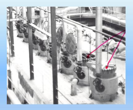
VT s pevnými trubkovnicemi, přepážkami v mezitrubkovém prostoru a dvěma tahy v trubkách HE with fixed tube-plates and baffles in inter mediate tube space and 2 passes in tubes
